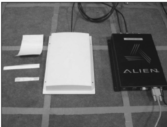
شکل ۲- راست: نمونه یک تگ RFID چپ: تگ خوان، آنتن و سه نوع تگ از شرکت Alien
